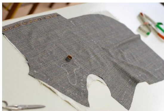
Unterschlagen der Einlage des Sakko-Vorderteils
